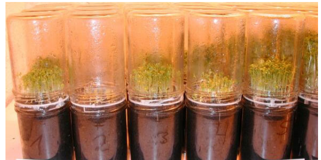
Substratprüfung mittels geschlossenem Kressetest
